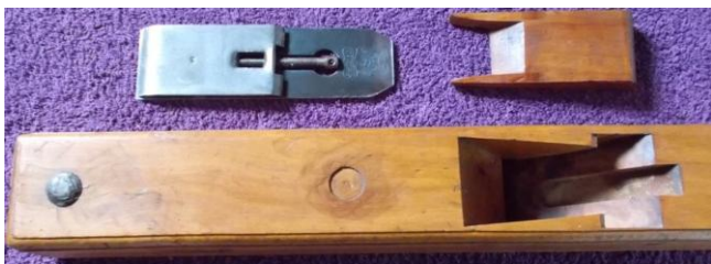
Varlope démontée : fer, coin, fût.
