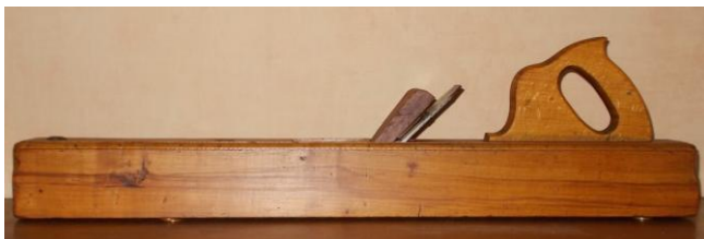
Varlope après rénovation.
