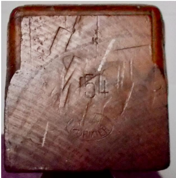
Nez de la varlope portant l'estampille VRAI CORMIER, le marquage 54 indiquant la largeur du fer, ainsi que des traces de coups.
